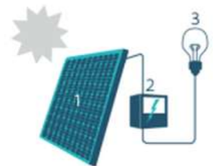
1. Zonnepaneel | 2. Omvormer | 3. Elektrische toestellen
